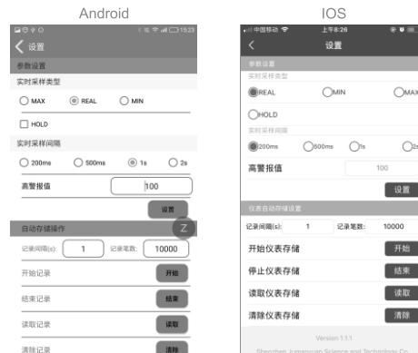
1.参数设置：实时采样类型，实时采样间隔和警报值的设置。
